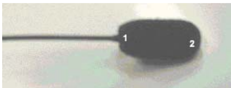
Figure 6-14. Exemple de bonnette pare-vent partiellement installée
