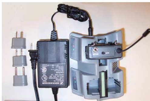
Figure 6-11. Chargement des packs d'accu
